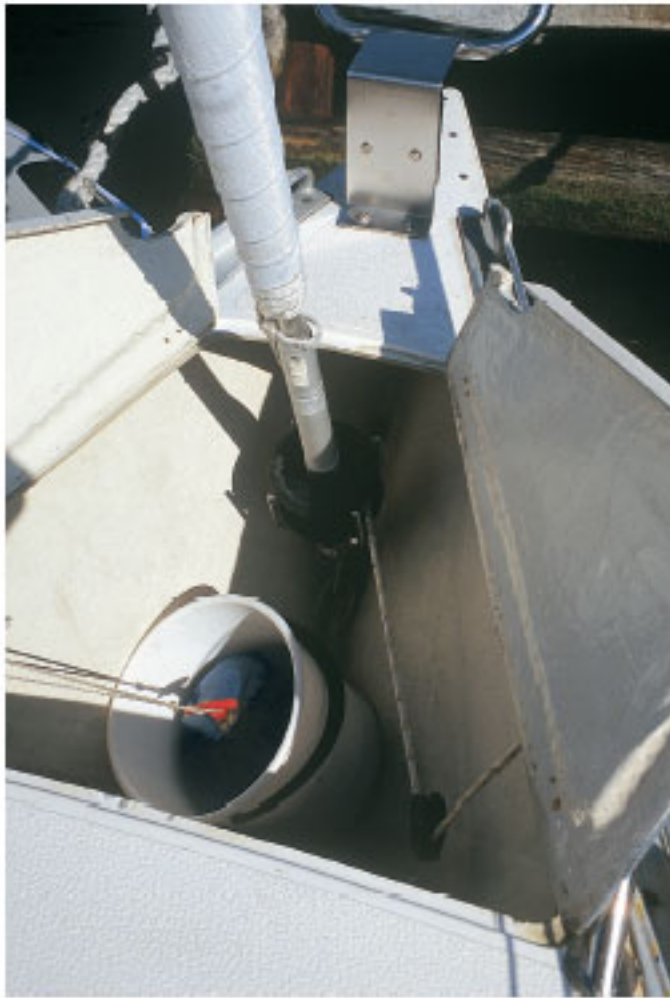
Med en rymlig ankarbox kan rulltrumman gömmas under däck. På sin båt har Lars Reutergårdh delat på pulpiten framtill och flyttat förstaget föröver för att få en större fock.
